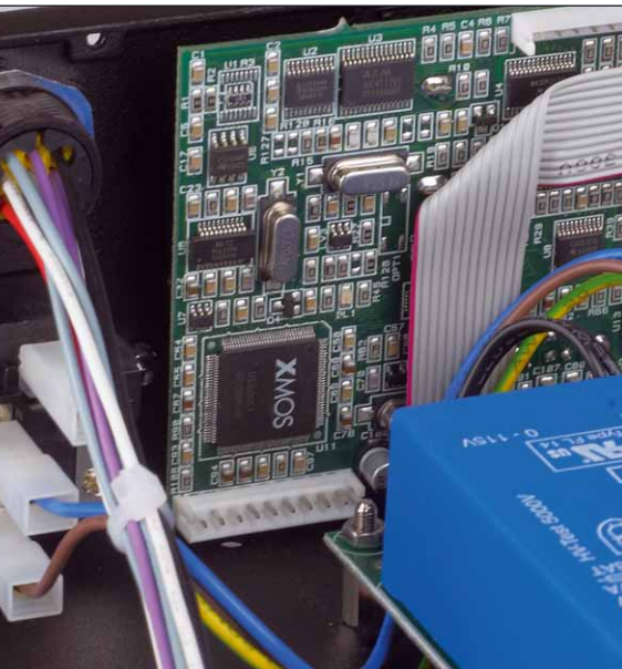
Zeitgemäß: XMOS-Receiver und AKM-Wandler. Ersterer ist für die über USB mögliche hohe Bandbreite verantwortlich
