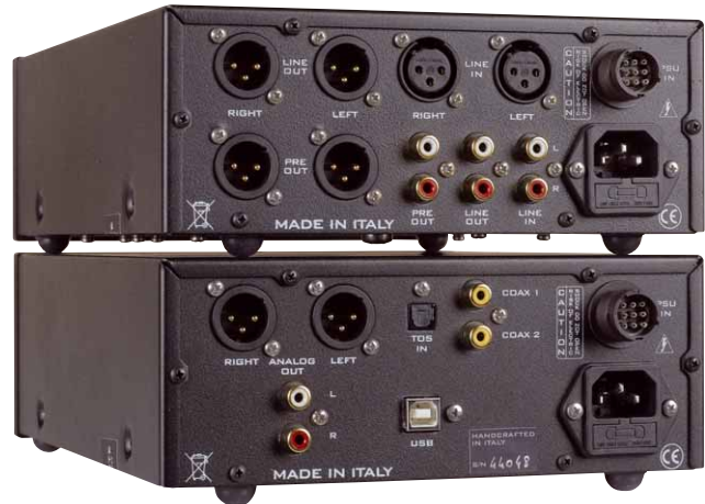
DAC und Vorstufe bieten die Option, über ein externes Netzteil gespeist zu werden
