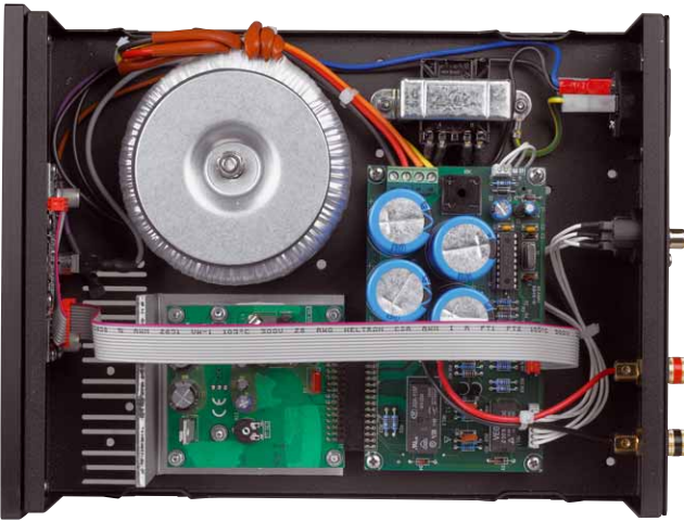
Die M-7 ist ein toll aufgebauter Schaltverstärker mit großem Trafo
